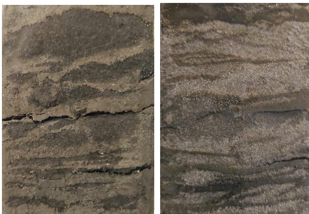
Figuur 45 Voorbeelden van gelaagde opbouw van Groninger wadzand
