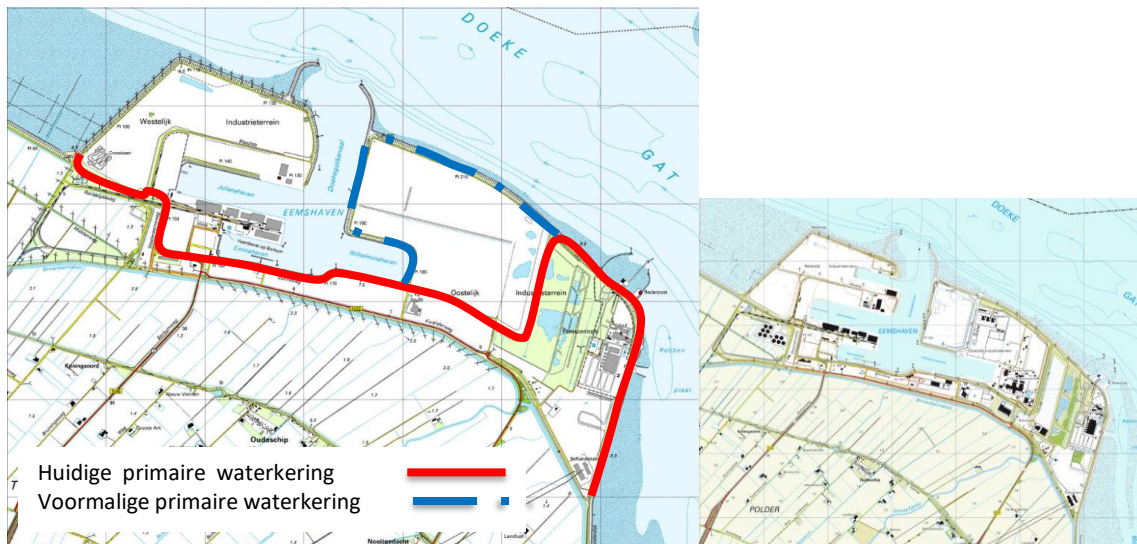
Figuur 14 Verlegging primaire waterkering Eemshavencomplex
