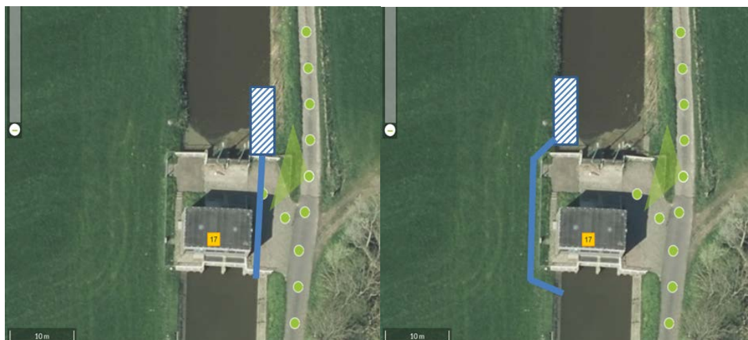
Figuur 5.2 Inpassingsmogelijkheden van de vispassage bij gemaal De Delthe
