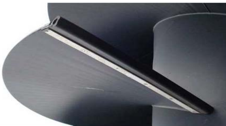
Figuur 5.3 Voorbeeld van een rubberstrip die fungeert als bumper
