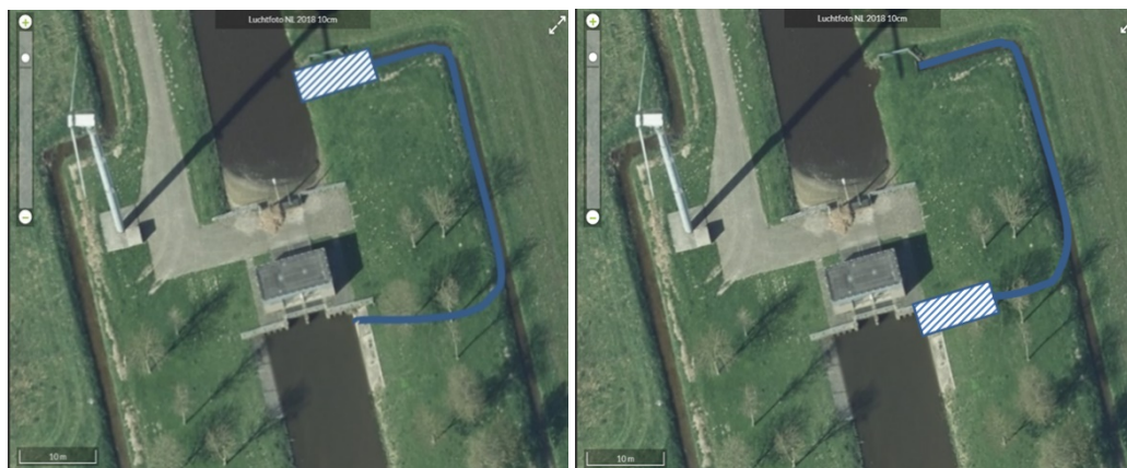
Figuur 5.1 Inpassingsmogelijkheden van de vispassage bij gemaal Sichterman
